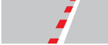
An Positionen, die doppelt belegt sein können (z. B. die Position D4 bzw. D4A/D4B), steht die Nutzung der Bereitstellflächen in Abhängigkeit zur geplanten Belegung der Positionen. Wenn die Hauptachse belegt ist (z. B. D4), darf die Bereitstellfläche vollständig genutzt werden. Wenn die Nebenachsen belegt sind (z. B. D4A/D4B) darf die Bereitstellfläche nur bis zu der roten unterbrochenen Positionsbegrenzung genutzt werden. Der Rest der Bereitstellfläche darf dann nicht genutzt werden.
