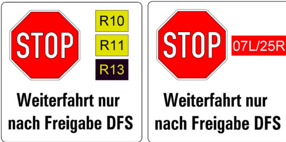
Nach Überqueren der letzten aufgeführten Rollbahn zeigt die Rückseite des Schildes an, dass man den Sicherheitsbereich der Rollbahn verlassen hat und gefahrlos halten kann.
