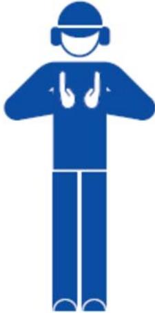
**Anheben** Beide Arme zum Fahrzeug ausgestreckt, Handflächen nach oben, Handbewegung nach oben
