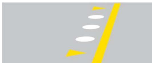
(4) Hilfsmarkierung für Fahrer von Flugzeugschleppern an den Ein- und Ausfahrten zu den Wartungsvorfeldern.
