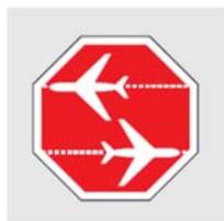
Wenn eine Fahrstraße zu einer Rollbereichsstraße wird, ist dies mit einer Markierung „Stop bei Rollverkehr“ gekennzeichnet. Die Rollbahnbegrenzungslinie darf zum Befahren der Rollbereichsstraße überfahren werden.
