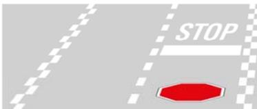
Der Anfang einer Rollbereichsstraße wird durch das Verkehrszeichen „Stop bei Rollverkehr“ gekennzeichnet. Hier muss angehalten werden, wenn sich ein Luftfahrzeug annähert.
