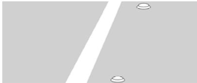
Die seitliche Begrenzung von Rollbahnen (Rollbahnseitenlinienmarkierung) ist mit einer doppelten gelben Linie mit blauer Befeuerung markiert.
