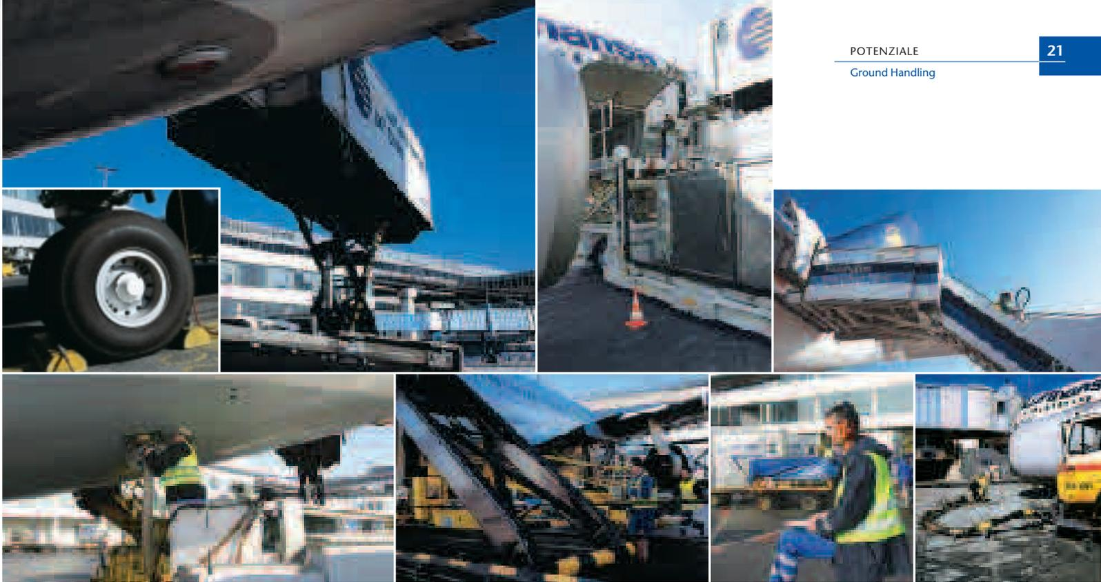
9.59 Uhr: Nach der Landung rollt die LH 4669 endlich auf ihre Position am Terminal 1. On blocks: Gelbe Bremsklötze fixieren das Flugzeug im Stand, die Bremsen werden gelöst, die Triebwerke abgeschaltet. Die Maschine wird an das Bodenstromnetz des Frankfurter Flughafens angeschlossen, das nach dem Abschalten der Triebwerke die schadstoffarme Energieversorgung wichtiger Bordsysteme wie beispielsweise der Klimatisierung garantiert.
