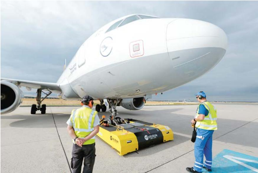
*Bis zu 50 Pushback-Vorgänge sind ohne Aufladen mit dem ferngesteuerten elektrischen Flugzeugschlepper möglich.*
