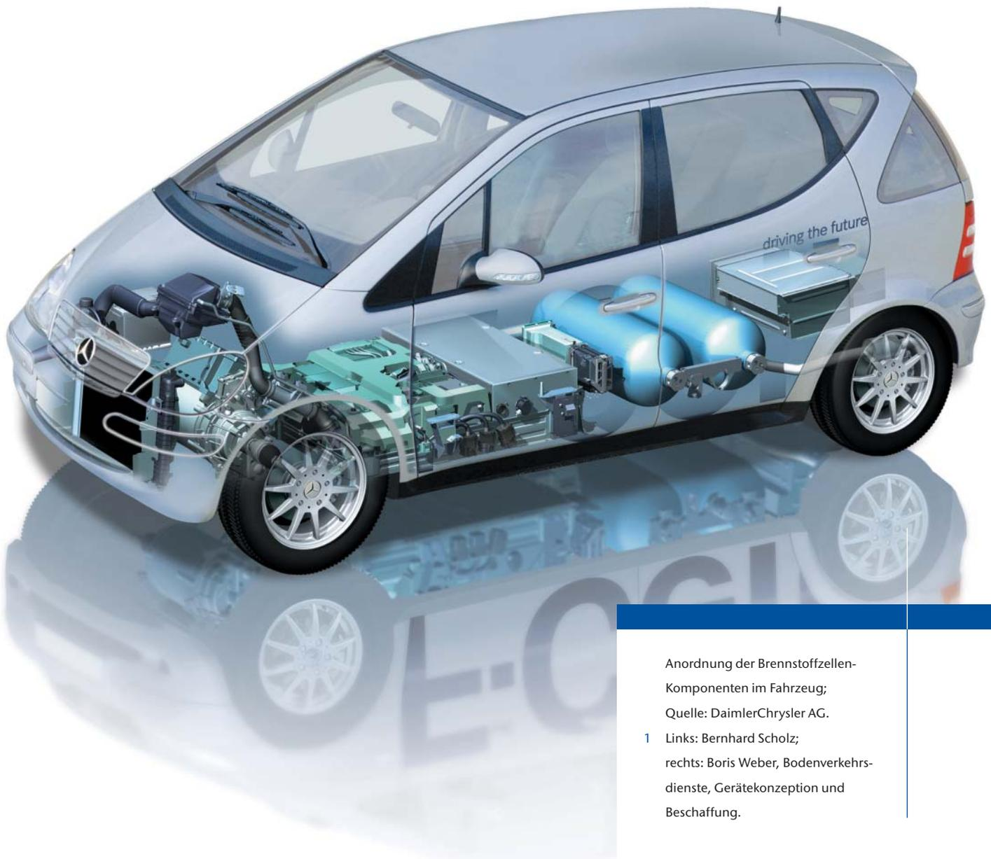
Anordnung der Brennstoffzellen-Komponenten im Fahrzeug;
