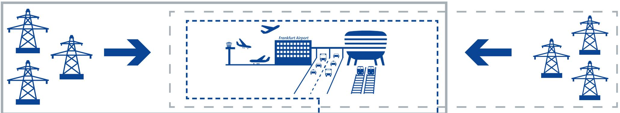
Sobald in einem Bereich des Flughafens der Strom ausfällt, springen automatisch Notstromaggregate an. Diese versorgen die sicherheits- und betriebsrelevanten Verbraucher (z.B. Aufzüge, Brandmeldeanlagen, Entrauchungsanlagen) mit Strom.
